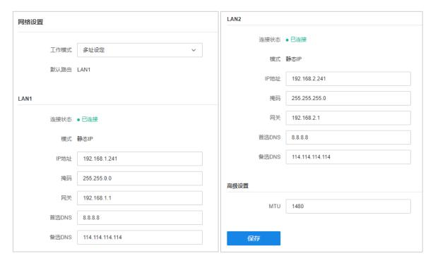
MTU MTU (Maximum Transmission Unit,最大传输单元),在一定物理网络中能传送的最大数据单元,可设置范围为 576~1500。
