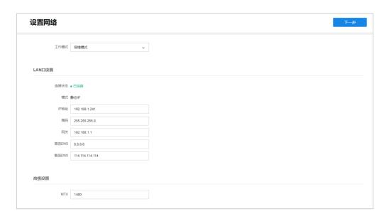
● 多址设定:两张网卡参数相互独立,网卡独立工作,可分别对 LAN1 和 LAN2 进行设置。可选择一张 网卡位默认路由,当系统主动连接外部网络时,数据由默认路由转发。
